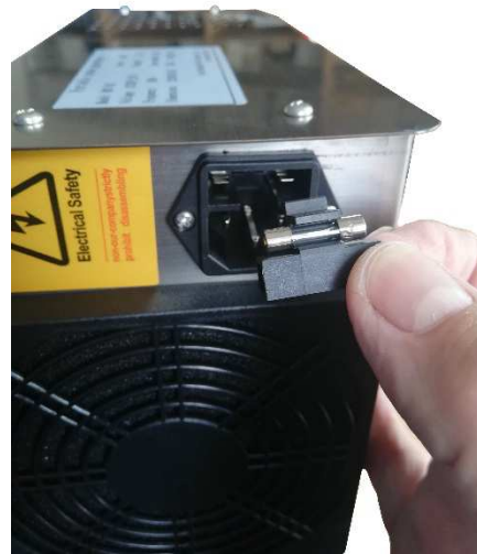
Vymeňte poistku v držiaku a potom držiak zasuňte naspäť do telesa konektora napájania
